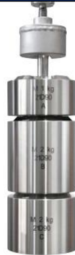
Gewichtskette 2 x 2 kg und 1 x 1 kg Die Gewichte werden mit einer Liniereinheit auf die Waage aufgesetzt.
